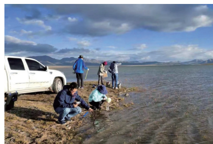
图3 在豆措（黄河上游）测定水文参数并采集水样
