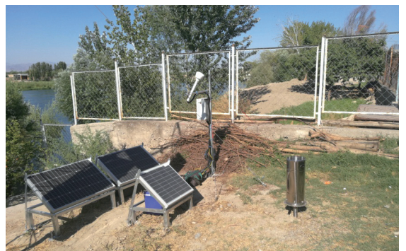
图3 锡尔河水文站雷达监测设备
