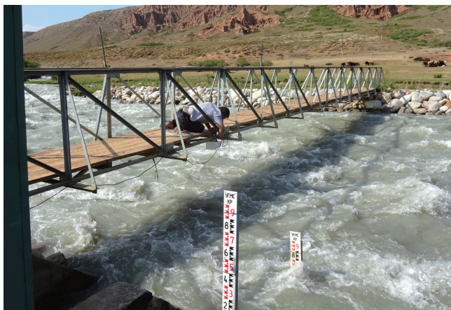
图2 安装雷达流量计
