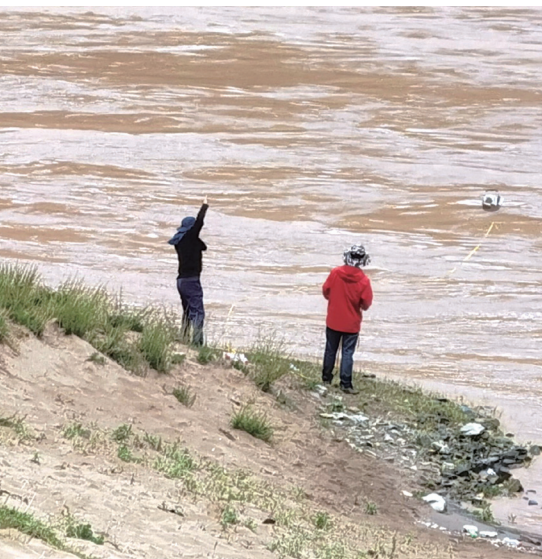
图2 取泥沙样——“通天飞”
